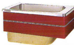
和洋折衷埋込式2方半エプロン(右・左有) HEW-1202K ¥131,000 間口1200×奥行730×高さ600%(満水量285ℓ) HEW-1102 ¥122,000 間口1095×奥行715×高さ590%(満水量260ℓ)
